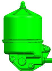
**Figure 3-27 Filtre à huile centrifuge à dérivation**
