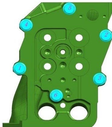
Fig. 3-2. Représentation schématique de la séquence de serrage des boulons du palier du vilebrequin
