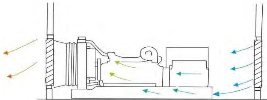
Vous pouvez fabriquer une prise d'air avec une plaque métallique ou en plastique. La prise d'air doit être reliée au radiateur de manière souple de sorte à isoler la transmission des vibrations et garantir que l'air chaud est bien extrait.
