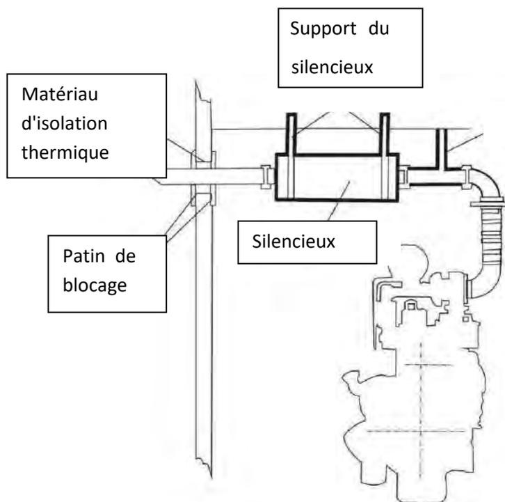
Le silencieux industriel monté sur l'unité est à absorption. Son principe de fonctionnement consiste à absorber le bruit grâce un garnissage d'absorption placé dans le silencieux. Ainsi il dispose d'une large plage de réduction de fréquence du bruit.
